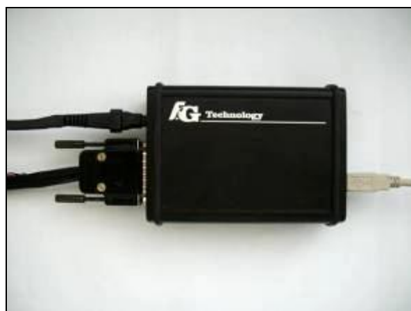
Figura 2: Cavo DB15 connesso all'interfaccia cable DB15 connect to the interface
